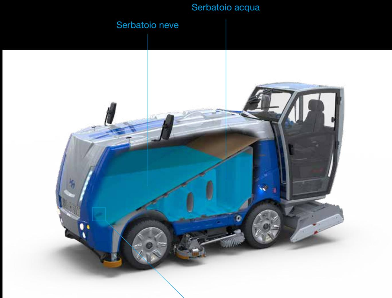
I serbatoi neve e acqua sono collegabili in un minuto, assicurando una disponibilità idrica di 2.000 litri. L'indicatore digitale sul display mostra lo stato di riempimento dei serbatoi collegati.
