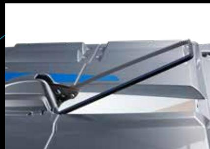
Grande sportello di ispezione trasparente ad apertura elettrica per una perfetta visibilità all'interno del serbatoio neve.
