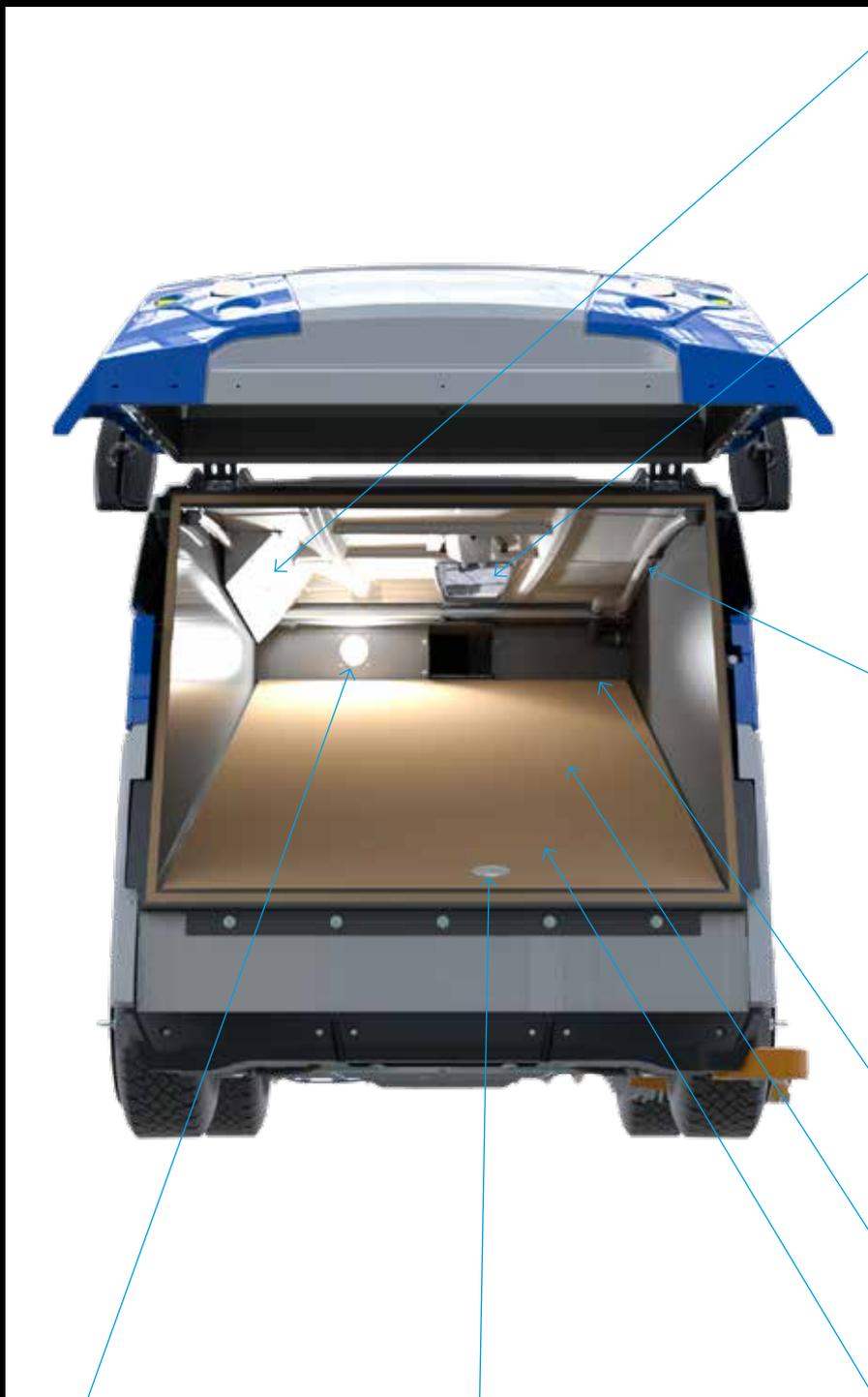
La ventilazione del serbatoio neve in combinazione con il sistema di ritenzione della polvere di neve garantisce un riempimento uniforme e compatto.
