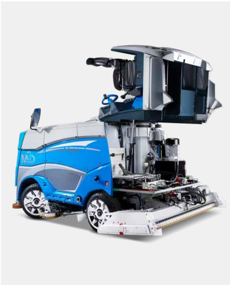
La Mammoth è il connubio perfetto tra design e robustezza: la sua parte posteriore, magistralmente realizzata in lega leggera resistente alla corrosione, assicura un peso totale bilanciato e un avanzamento dinamico ed efficiente. La distribuzione ottimale del peso tra l'asse anteriore e quella posteriore, assieme al baricentro basso, garantiscono un'eccellente tenuta di strada sulle superfici ghiacciate.
