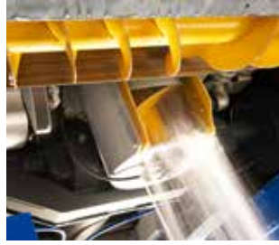
Impianto di lavaggio coclea verticale Può essere attivato durante la lavorazione del ghiaccio
