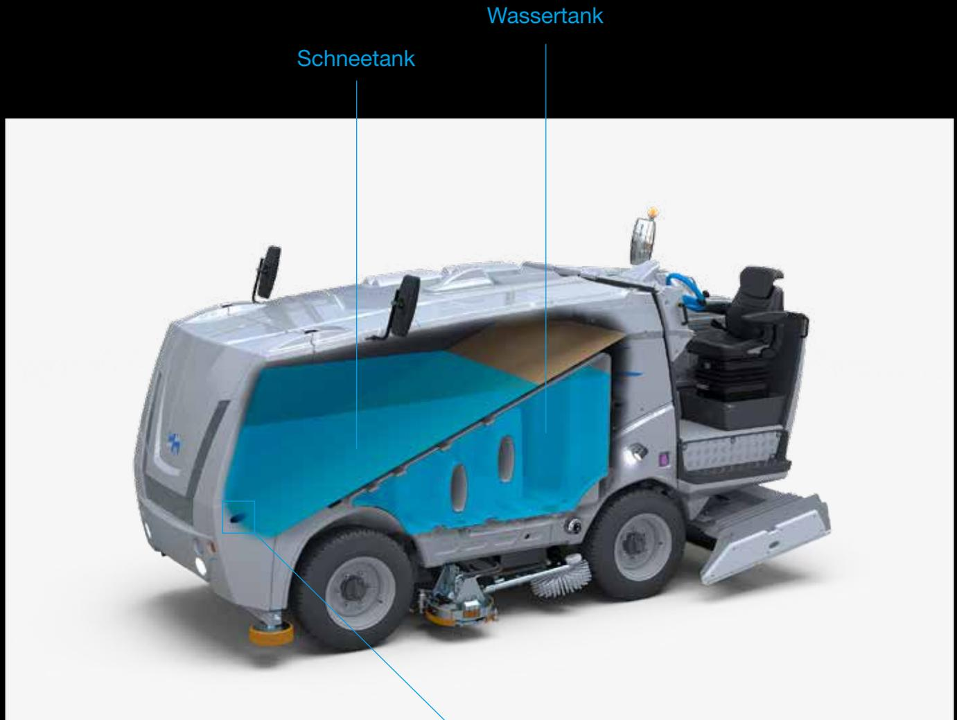
In nur einer Minute sind die Schnee- und Wassertanks miteinander verbunden und bieten eine Wasserkapazität von 2.000 Litern. Ein digitales Display zeigt den Füllstand der Tanks an.
