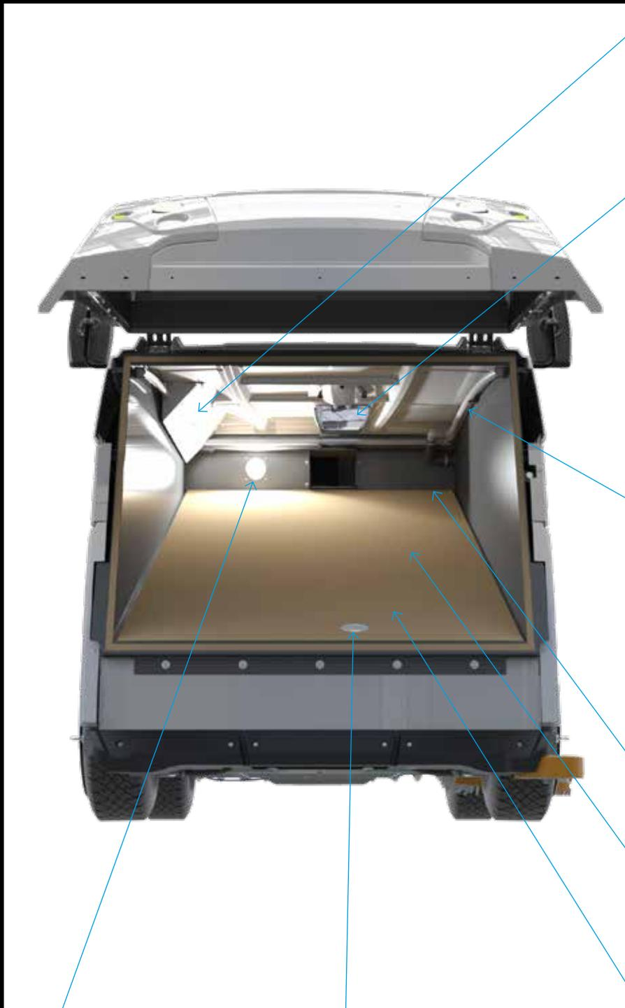
Die Entlüftung des Schneetanks in Kombination mit dem Schneestaub-Rückhaltesystem gewährleistet eine gleichmäßige und kompakte Befüllung.
