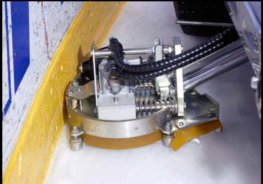
Die Kombination aus schwenkbarer Bürste und Bandenfräser ermöglicht das Fräsen und anschließende Reinigen der Eisfläche in nur einem Arbeitsgang. Der Fräser befindet sich zwischen den Achsen und vor der Bürste, was einen hervorragenden Überblick von der Maschine aus bietet. Wenn er nicht gebraucht wird, bleibt der Bandenfräser unscheinbar zwischen den Rädern verborgen.
