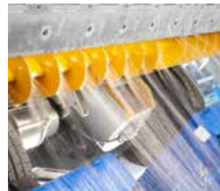
Schnecken- waschanlage horizontal kann während der Eisbearbeitung aktiviert werden
