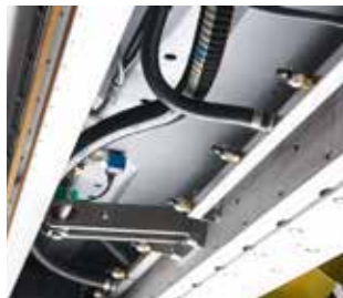
Eiswaschanlage Multijet mit Absaugleiste
