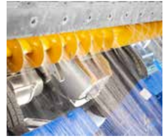
Impianto di lavaggio coclea orizzontale
