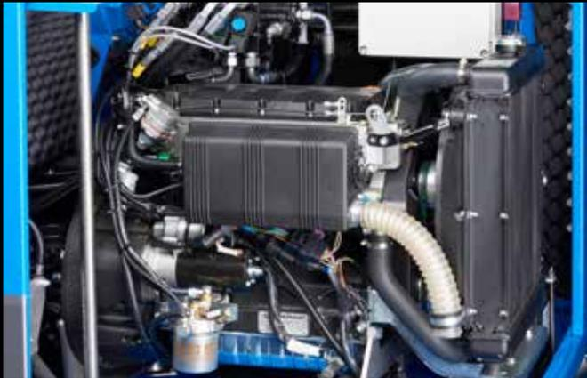
Vano motore diesel
