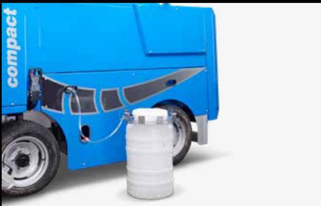
Sistema di riempimento della batteria
