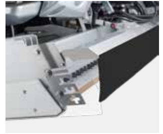
ICEplus Flexi Wassersprühsystem + automatischer Wischtuchheber
