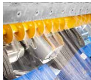
Impianto di lavaggio coclea orizzontale Può essere attivato durante la lavorazione del ghiaccio
