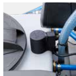
Sensore di livello liquido all'interno del serbatoio
