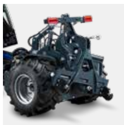
Telaio attacco ai tre punti categoria 1, oscillante 15° e spostamento laterale
