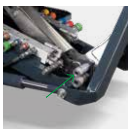
Collegamenti alla seconda pompa ad ingranaggi
