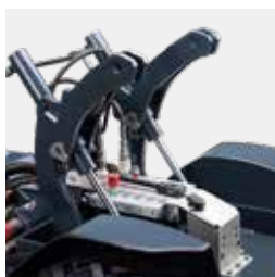
Sollevatore con distributore idraulico
