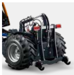
Telaio attacco ai tre punti categoria 1
