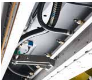
Sistema di lavaggio ghiaccio Multijet con barra di aspirazione
