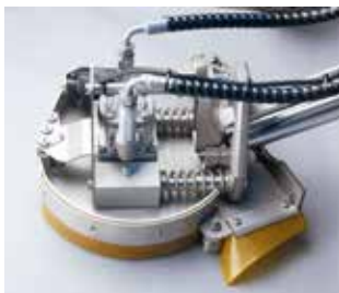
Fresabordi in acciaio inossidabile, molleggiata e regolabile elettricamente in altezza
