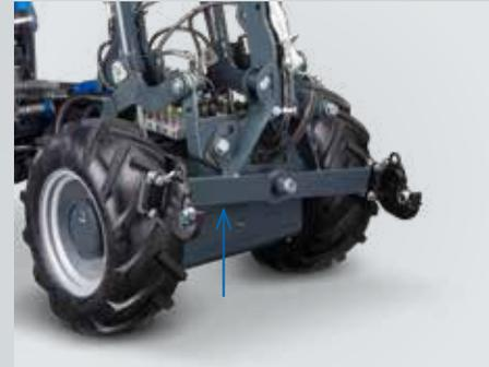
Der hydraulisch schwenkbare Anbaurahmen ermöglicht das seitliche Schwenken der Zusatzgeräte um  $\pm 8^\circ$  (Optional).
