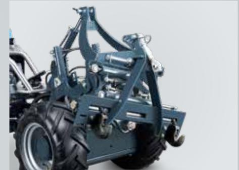
Der hydraulisch schwenkbare Anbaurahmen mit Seitenverschub ermöglicht das seitliche Schwenken der Zusatzgeräte um  $\pm 15^\circ$  und einen Seitenverschub des Anbaugerätes um  $\pm 150$  mm.
