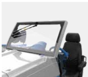
Parabrezza in vero vetro con sistema tergicristallo
