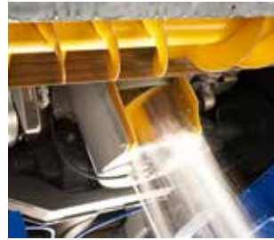
Impianto di lavaggio coclea verticale
