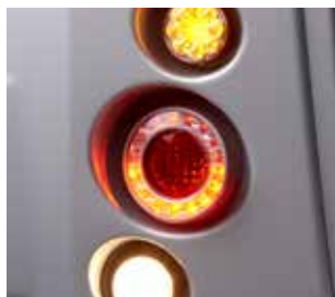
Luce posteriore, luce di posizione e luce dei freni
