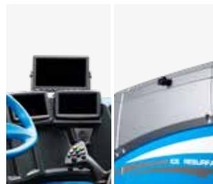
Zwei Kameras mit Display 10" mit Aufnahmefunktion
