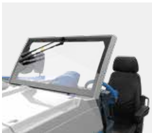
Windschutzscheibe aus Echtglas mit Scheibenwischanlage
