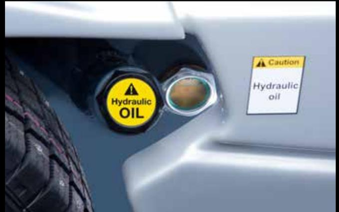
Gute Sicht: Hydraulikölstandsanzeige
