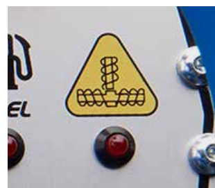
Sistema di avvertimento coclee in sovraccarico
