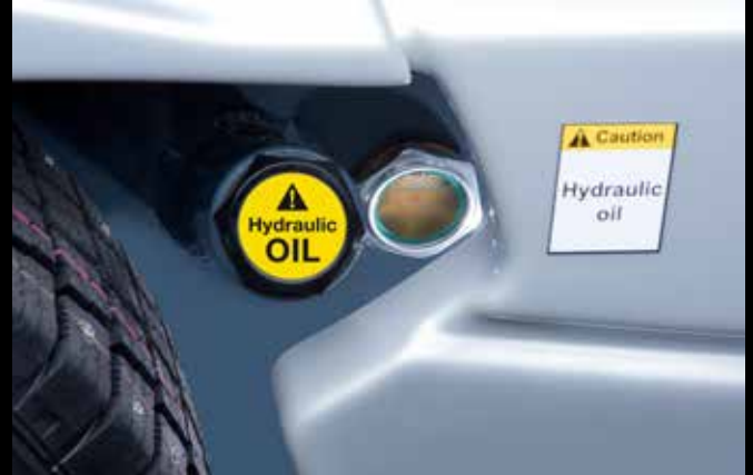
Buona visibilità: spia in vetro dell'olio idraulico
