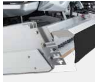
ICEplus Flexi Wassersprühsystem + automatischer Wischtuchheber
