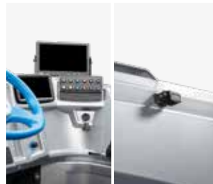
Zwei Kameras mit Display 10" mit Aufnahmefunktion
