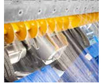
Schnecken- waschanlage horizontal kann während der Eisbearbeitung aktiviert werden
