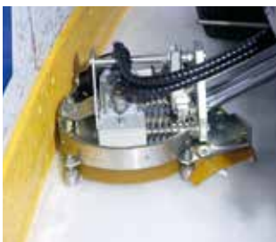
Bandenfräser aus verzinktem Stahl, gefedert und elektrisch höhenverstellbar
