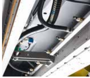
Eiswaschanlage Multijet mit Absaugleiste
