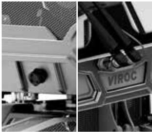
14-Pin-Kabeldurchführung mit Front- & Heckanschluss
