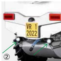
2 LED-Arbeitsleuchten für HQS
