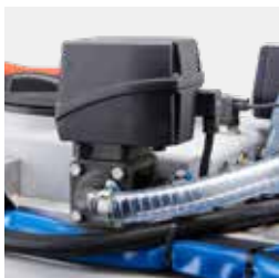
3-Wege-Ventil, vom Monitor aus elektrisch steuerbar (Behandlung / Spülung)
