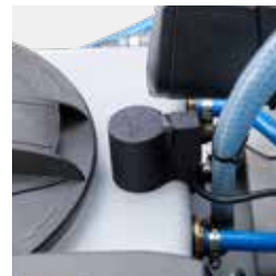
Füllstandsensoren im Tank
