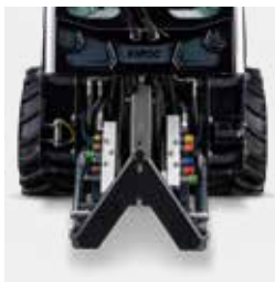
Hydraulikblock mit 12V-Steckdose
