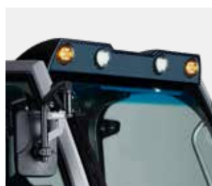
Beleuchtung für den Straßenverkehr
