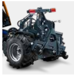
Dreipunktanbau- rahmen Kat. 1, schwenkbar (15°) und mit Seitenvershub
