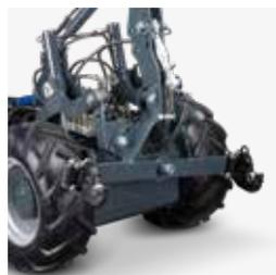
Telaio di fissaggio oscillante  $\pm 8^\circ$  Categoria 1
