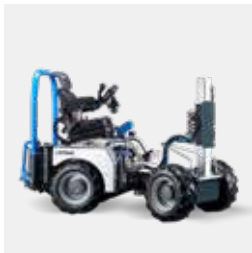
Gerätemast mit Hydraulikblock
