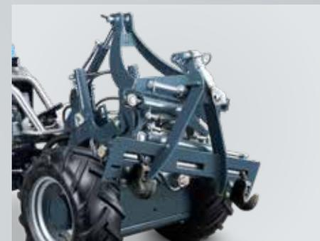
Il telaio di montaggio orientabile idraulicamente con spostamento laterale consente la regolazione laterale dell'attrezzo di  $\pm 15^\circ$  e lo spostamento, sempre laterale, di  $\pm 150$  mm.
