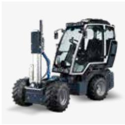
Gerätmast mit Hydraulikblock & zusätzlichen hydraulischen Funktionen
