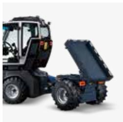
Telaio con dispositivo di ribaltamento idraulico
