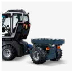
Telaio con dispositivo di ribaltamento manuale
