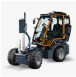
Gerätmast mit Hydraulikblock & zusätzlichen hydraulischen Funktionen
