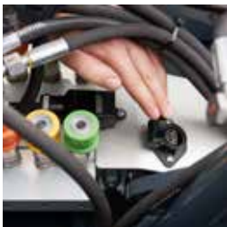
12V-Steckdose schaltbar nach DIN 9680
