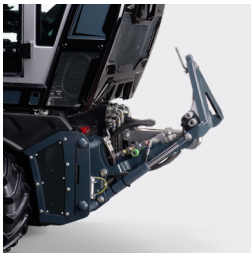
Fronthubwerk mit Kupplungsdreieck Kat. 0
