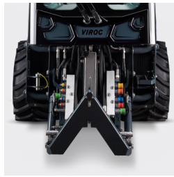
Hydraulikblock mit 12V-Steckdose
