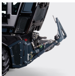
Sollevatore anteriore con triangolo di attacco cat. 0
