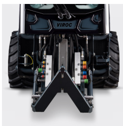
Gruppo idraulico e presa 12V
