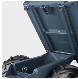
Rahmen mit manueller Kippfunktion
