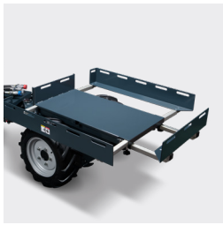
Transportbrücke (in Länge & Breite einstellbar)
