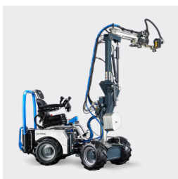
Laubschneider LSU mit hydraulischen Funktionen
