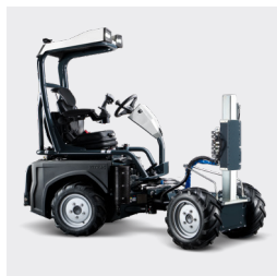
Albero portattrezzi con distributori idraulici
