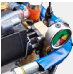
Sensore di pressione e regolatore pressione elettrico
