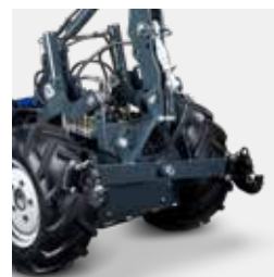
Telaio di fissaggio oscillante \pm 8^\circ Categoria 1
