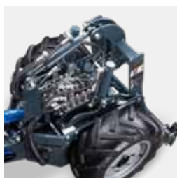
Distributore idraulico con 1 cilindro libero per ulteriori movimenti
