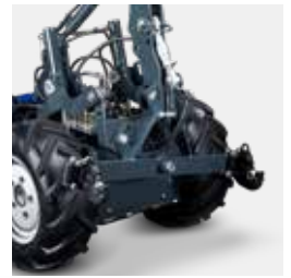
Dreipunktanbau-rahmen Kat. 1, schwenkbar (±8°)
