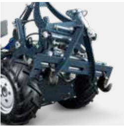
Dreipunktanbau-rahmen Kat. 1, schwenkbar (±15°) und mit Seitenvershub
